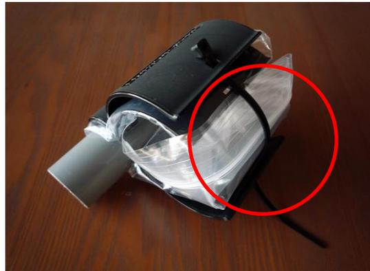
水道管(水量計の私有地側)に元付けを被せ、挟み込み様にして取り付けてください。その後、本体とカバーを回転(90度~180度)させて、添付の結束バンドを元付け用カバーの片側の孔から通し、もう一方の穴へ通します。
